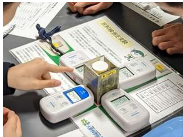
ガンマ線簡易測定器による遮蔽の実験
