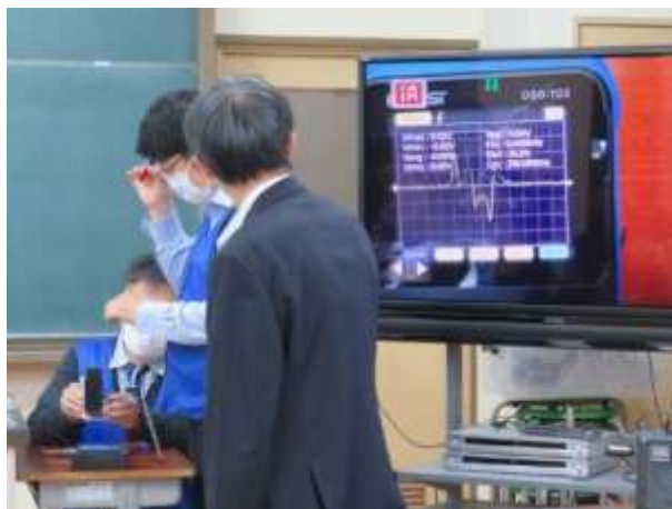
オシロスコープによる磁界変化時の電圧測定
